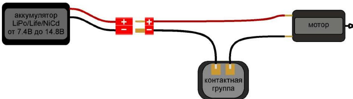
При установке электронного ключа Arm-V контактная группа коммутирует только управляющее напряжение и не несет никакой нагрузки.
