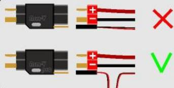
Рекомендация: управляющие провода должны быть длиннее силовых на 1 см. Это позволит избежать их самопроизвольного отключения.
