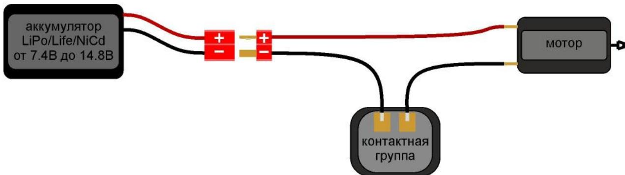
При установке **Arm-V pro3** контактная группа коммутирует только управляющее напряжение и не несет никакой нагрузки.
